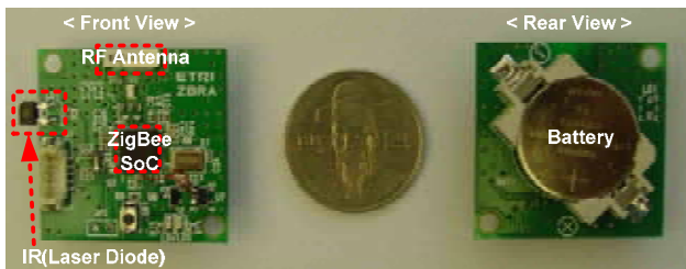
Fig. 8. ZigBee to IR(Z2IR) Conversion Module
